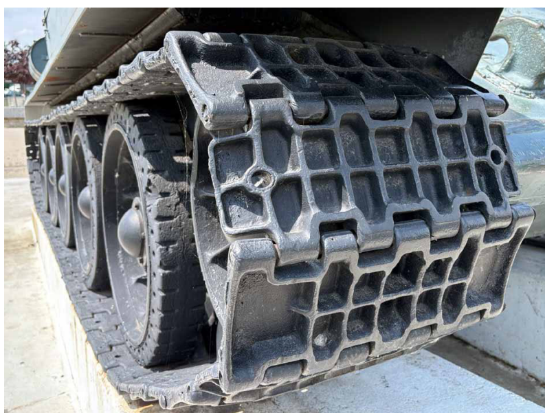
Przykład ogniw gaśienicy czołgowej. Ich produkcja wymagała znacznie bardziej zaawansowanej infrastruktury niż wytwarzanie łańcuchów przeciwpoślizgowych. Zdjęcie: Marian Gabrowski
